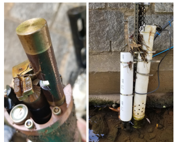
Sonde EXO avec ses capteurs de température de l'eau, conductance, pH, DO, turbidité, chlorophylle et phycocyanine.
